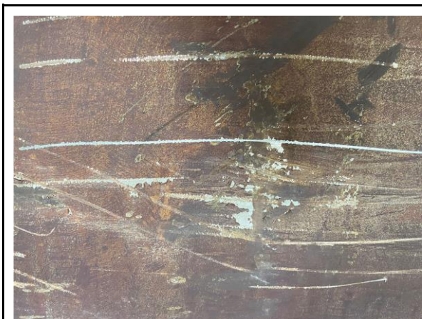
Figura 45 - Mesa em aço corten, detalhe das abrasões e perdas
